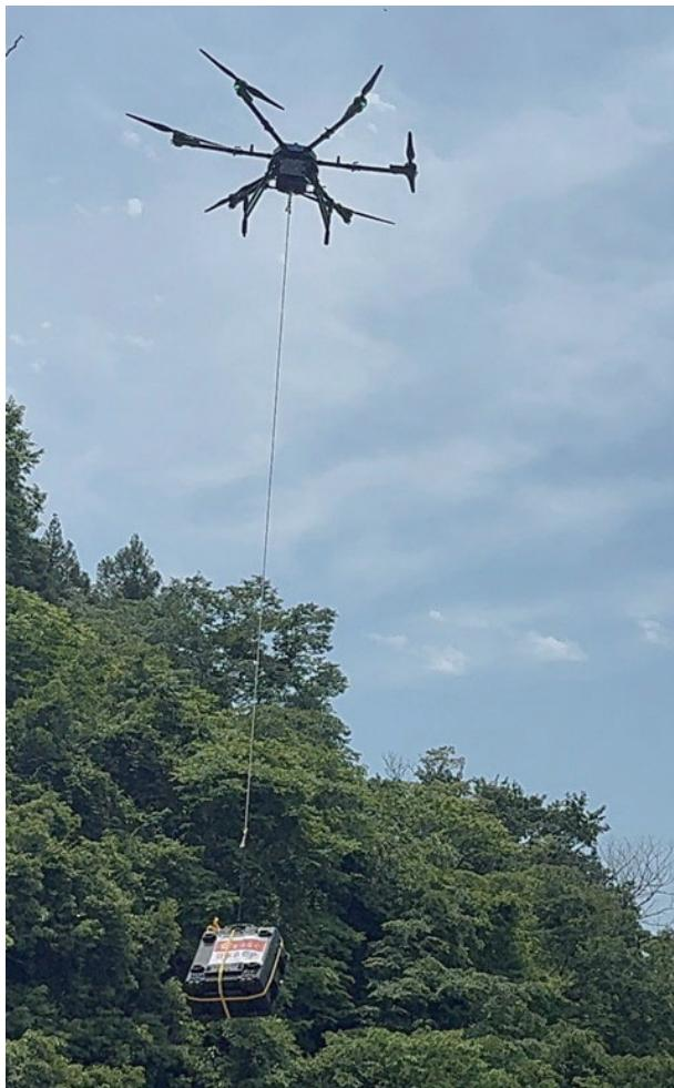
2025 年 5 月 21 日、過去の災害対応の教訓を踏まえ、当社が防災協定を締結している神奈川県松田町寄の中津川周辺において災害時を想定したドローンによる燃料（ガソリン・LP ガス等）運搬の実証実験を実施いたしました。今回は、株式会社 Autonomy（東京）社製の国産大型物資運搬用ドローン「Surveyor-X」を使用し、燃料等の吊り下げによる運搬の検証を行いました。当日は、比較的穏やかな風（最大 3.9m/s）にもかかわらず運搬物は風の影響で若干の揺れがみられましたが、機体はまったく揺れることなく安定した飛行状態を確認することができました。また、荷吊り場・荷受け場において、当社スタッフとドローン運航会社スタッフとの連携要領等を検証し、災害対応時における教訓と今後の課題を明確にすることことができました。さらに、実験会場には神奈川県議会議員、松田町役場、関西大学の関係者をはじめ、見学者の皆様にご来場いただくとともに、ネット配信を通じて実験の様子を多くの関係者の皆様にご覧いただきました。
